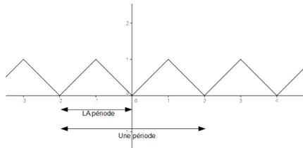
FIGURE 1 – Exemple de la courbe d'une fonction périodique
