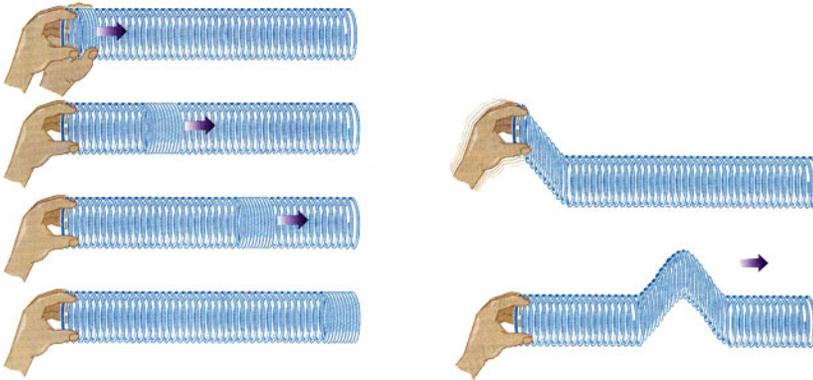
**Remarque 1.1.1.** Le son est en fait une onde longitudinale, l'air ayant la capacité de se déformer grâce à son élasticité (de la même manière que le ressort sur l'image à gauche) mais sans que cette déformation soit visible.
