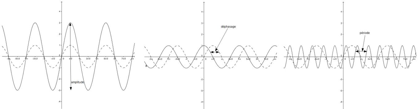
FIGURE 3 – Sinusoïde et fonction  $\sin$
